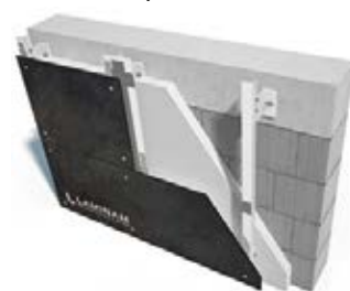
Система с использованием вытяжных заклёпок
