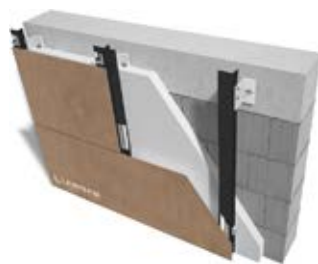
Система с прямым приклеиванием
