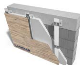
Система с использованием кляммеров
